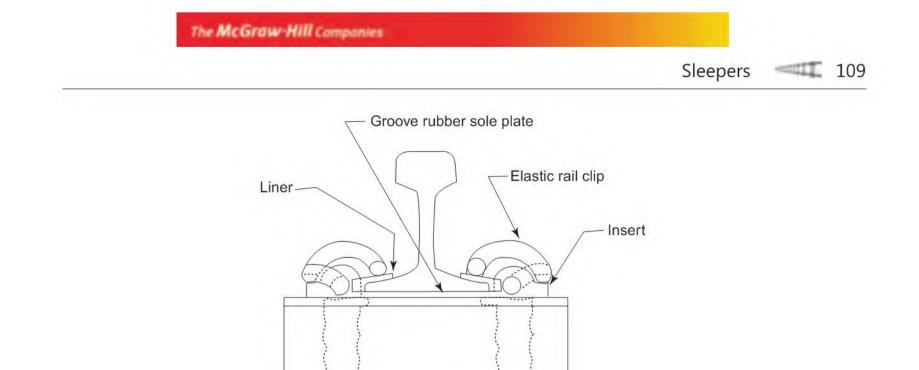
Fig. 4.13 (d) Details at the rail seat
