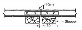
Fig. 3.5 (d) Semi-supported/suspended joint
