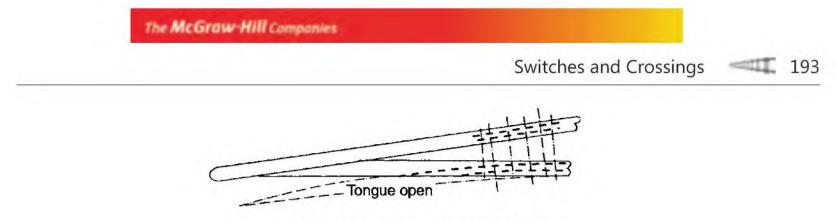
Fig. 7.4 Loose heel switch
