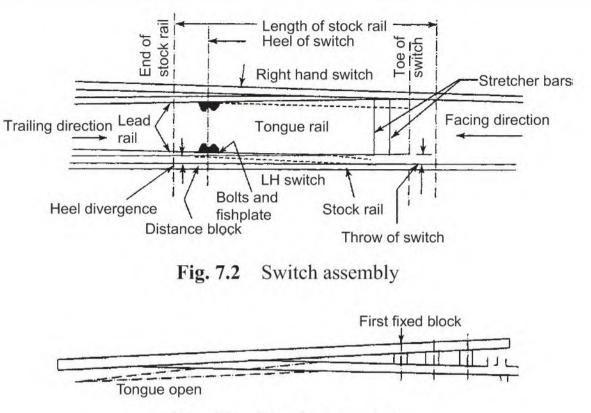
Fig. 7.3 Fixed heel switch
